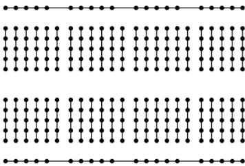
Fig. 2: The internal contact rows (Kontakte.gif)
