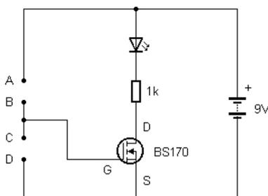
Fig. 38: Basic MOSFET circuit (Schaltung14.jpg)
