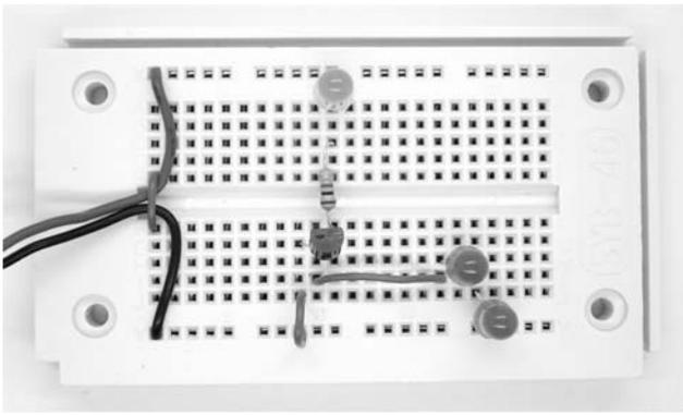
Fig. 45: The light sensor (Aufbau17.jpg)
