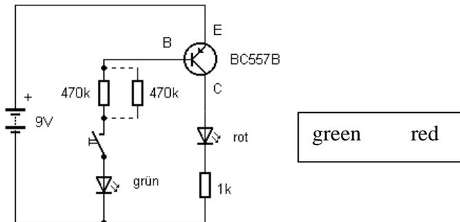
Fig. 14: A PNP transistor in the emitter circuit (Schaltung2.jpg)
