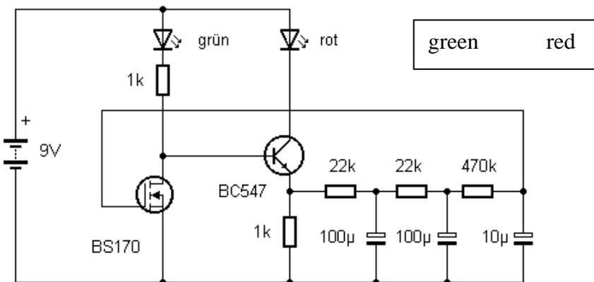
Fig. 50: A phase shifter oscillator (Schaltung20.jpg)
