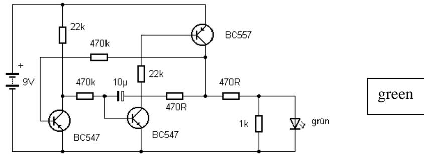
Fig. 36: The flashing light circuit (Schaltung13.jpg)
