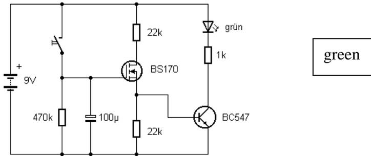
Fig. 48: Slow capacitor discharge (Schaltung19.jpg)
