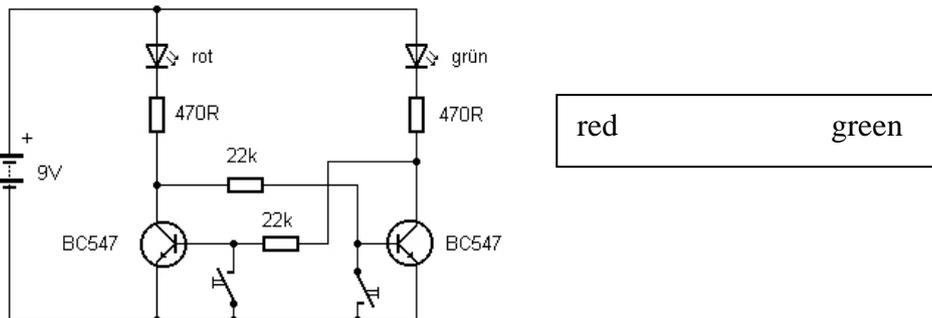
Fig. 28: A bistable flip-flop (Schaltung9.jpg)
