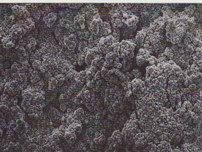
Eine neue ungenutzte Batterieplatte, wie sie in einer fabrikneuen Batterie aussehen sollte.
