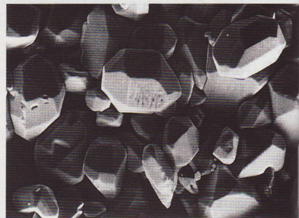
Nach 2 Jahren Laufzeit stark geschädigte Batterieplatte. Auffallend die starke Kristallbildung (sog. Sulfatierung), wodurch die Batterie kaum noch in der Lage ist, Ladung aufzunehmen.
