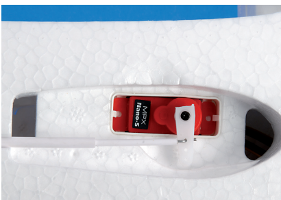
Die Servos für Höhen- und Seitenruder sind schon eingebaut
