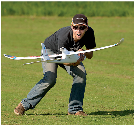
Vor dem Erstflug müssen nur noch Empfänger und geladener LiPo-Akku angeschlossen werden
