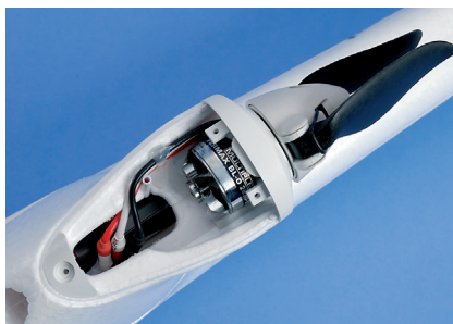
Jetzt sorgt ein potenter Permax BL-0 2830-100 mit einer 7"x6"-Klappflugschraube für Vortrieb
