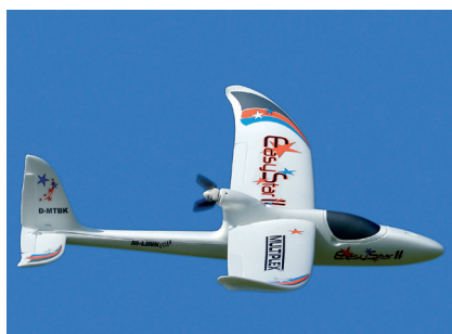
Wenn der Motor ausgeschaltet wird, legt sich die Luftschraube strömungsgünstig am Spinner an
