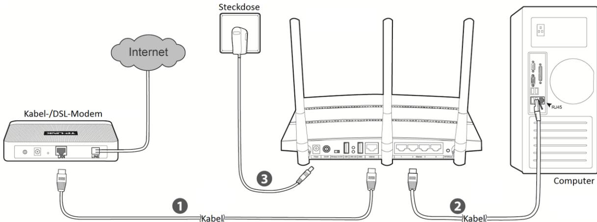
Bild 2-1 Hardwareinstallation
