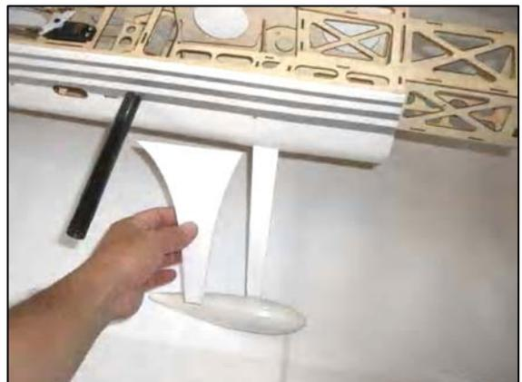
Danach passen Sie die Fahrwerksverkleidung an. Prüfen Sie die genaue Ausrichtung des Fahrwerks und der Verkleidung zum Rumpf.
