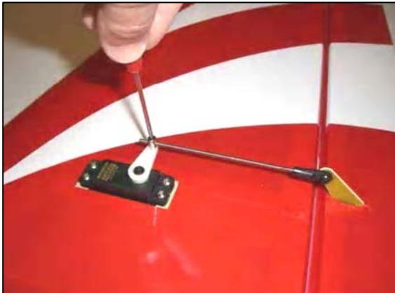
Montieren Sie das Querrudergestänge, wie es das Bild zeigt.
