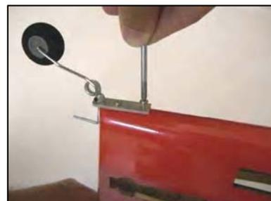
Mit den beigefügten Kreuzschlitzschrauben befestigen Sie das Heckrad am Rumpf, wie in der Abbildung dargestellt.
