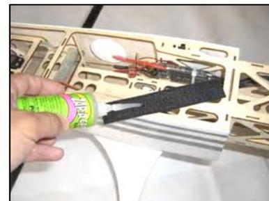
Befestigen Sie mit einigen Tropfen medium CA-Kleber einen Klettbandstreifen an der abgebildeten Stelle und drücken ihn fest an. Auf diesem Streifen wird der Akku, der mit dem Gegenstück ausgestattet wird, befestigt. Die beiden Bilder zeigen diese Arbeiten.
