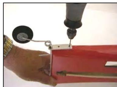
Passen Sie das Fahrwerk am Rumpf an und bohren Sie mit einem 1,5 mm Bohrer zwei Löcher.
