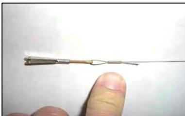
Bereiten Sie die beiden Seilzüge für die Anlenkung des Seitenruders vor. Das Bild zeigt diesen Arbeitsschritt.
