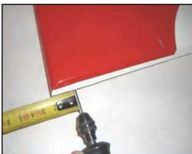
Bohren Sie 20 mm von der Unterkante ein Loch mit einem 2 mm Bohrer in das Seitenruder. In dieses Loch wird der Mitnehmer der Spornra-
