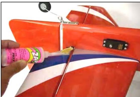
Danach kleben Sie mit medium CA-Kleber das Ruderhorn ein. Setzen Sie nur wenig Kleber ein, damit das Ruder sich nicht mit dem Leitwerk verklebt. Danach bringen Sie das Höhenrudergestänge an, wie im nächsten Bild dargestellt.
