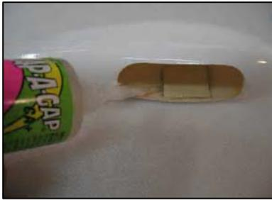
stärkungsbrettchen aus Holz und verkleben Sie es mit medium CA-Kleber. Danach durchbohren Sie das Brettchen mit einem 3 mm
