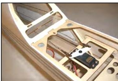
So werden die Seile am Seitenruderservo eingehängt.
