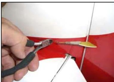
Fädeln Sie die Seilzüge ein und verquetschen Sie die Enden sicher in den Hülzen, so dass die Seile straff gespannt sind.
