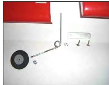
Montieren die Komponenten des Heckfahrwerks, wie auf den nächsten Bildern dargestellt, mit Hilfe einer Flachzange.
