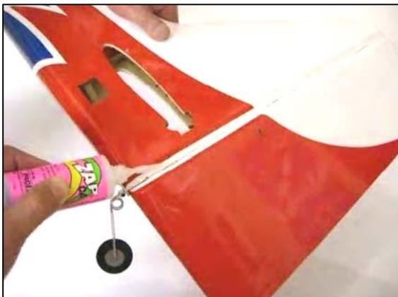
Danach stecken Sie das Seitenrunder auf und verkleben mit wenig dünnflüssigem Sekundenkleber die Scharniere am Ruderblatt.
