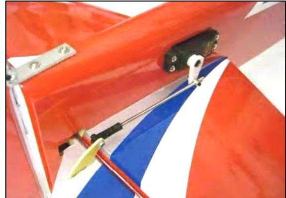
**12. Abschnitt 6: Seitenruderservo und -gestänge montieren**
