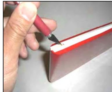
dankeung geklebt. Bringen Sie mit einem scharfen Klingemesser eine Nut für den Fahrwerksdraht in der Seitenruderrille an.
