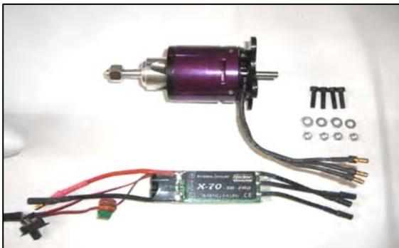
Die beste Motorisierung erhalten Sie mit dem angegebenen Hacker-Außenläufer und dem zugehörigen Controller. Legen Sie sich alle Komponenten des Antriebs zurecht, wie es das Bild zeigt.
