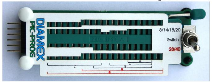
Der Diamex PICProg Schwenkhebler ist für PICs im DIL 40,28,20,18,14 und 8 Gehäuse geeignet. Sie benötigen noch einen DIAMEX-PICProg- oder einen PICKit2 kompatiblen Programmer, den Sie direkt auf die 6polige Steckerleiste aufstecken können. Beispielsweise wie abgebildet:
