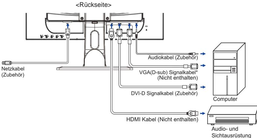
\* Das VGA (D-Sub)-Kabel ist nicht im Lieferumfang enthalten. Für den Betrieb über VGA benötigen Sie ein spezielles VGA (D-Sub-Kabel) für dieses Modell. Bitte kontaktieren Sie das iiyama Support Center in Ihrem Land, wenn Sie den Monitor über den VGA-Eingang anschließen wollen.
