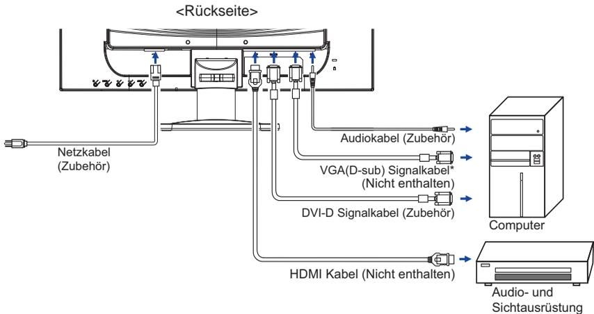
\* Das VGA (D-Sub)-Kabel ist nicht im Lieferumfang enthalten. Für den Betrieb über VGA benötigen Sie ein spezielles VGA (D-Sub-Kabel) für dieses Modell. Bitte kontaktieren Sie das iiyama Support Center in Ihrem Land, wenn Sie den Monitor über den VGA-Eingang anschließen wollen.
