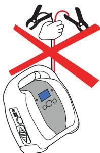
Der Starthilfekabel Anschluss muss im Gerät einrasten. Es ist eine gewisse Kraft erforderlich um die Verbindung herzustellen oder wieder zu trennen. Dies ist normal da eine exakte Verbindung, wegen der hohen Ampere Leistung bei Starthilfe, notwendig ist.
