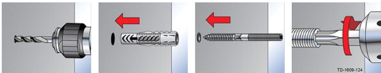
Anleitung zum Setzen der Dübel und Schrauben. Quelle: Fa. Fischer
