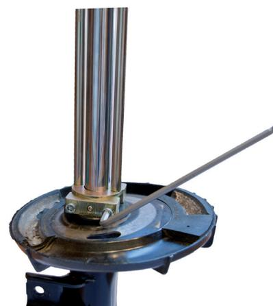
**Nach dem Lösen der Zugvorrichtung Feder mit Staukappe und Federteller montieren. Unter der Staubkappe anschließend die Klemmvorrichtung entfernen.**
