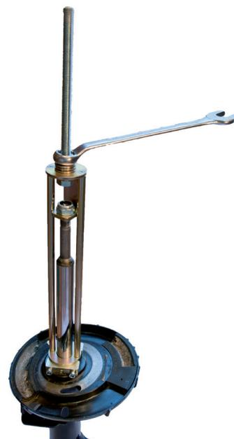
**Die Klemmvorrichtung mit einem 5-mm-Inbusschlüssel an der Kolbenstange fixieren.**
