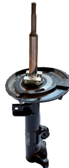
**Zugvorrichtung über die Kolbenstange stülpen und den Zughaken mit der Mutter verschrauben.**
