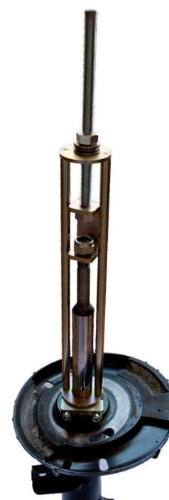
**Die Kolbenstange nun mit der Zugvorrichtung bis zum Anschlag herausziehen.**
