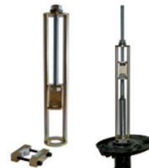
**Die Klemmvorrichtung über die Kolbenstange stecken (nicht festziehen)**
