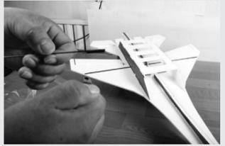
16. Sie können sie mithilfe von Schrumpfschläuchen zusammenbauen. Wenn Sie zum Schluss noch etwas Klebe hinzufügen, werden sie sehr robust sein.
