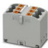
Verteilerblock, Grundklemme, Nennspannung: 450 V, Nennstrom: 24 A, Anschlussart: Push-in-Anschluss, Anzahl der Anschlüsse: 6, Querschnitt: 0,14 mm<sup>2</sup> - 4 mm<sup>2</sup>, AWG: 26 - 12, Breite: 16 mm, Höhe: 21,7 mm, Farbe: grau, Montageart: aufrasten auf Tragschienenadapter
