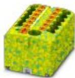
Verteilerblock, Grundklemme mit Einspeisung, Nennspannung: 450 V, Nennstrom: 24 A, Anschlussart: Push-in-Anschluss, Push-in-Anschluss, Anzahl der Anschlüsse: 13, Querschnitt: 0,14 mm<sup>2</sup> - 4 mm<sup>2</sup>, AWG: 26 - 12, Breite: 41 mm, Höhe: 21,7 mm, Farbe: grün/gelb, Montageart: Fliegend, Direktmontage mit Flansch, kleben
