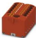
Verteilerblock, Grundklemme mit Einspeisung, Nennspannung: 450 V, Nennstrom: 24 A, Anschlussart: Push-in-Anschluss, Push-in-Anschluss, Anzahl der Anschlüsse: 13, Querschnitt: 0,14 mm<sup>2</sup> - 4 mm<sup>2</sup>, AWG: 26 - 12, Breite: 41 mm, Höhe: 21,7 mm, Farbe: rot, Montageart: aufrasten auf Tragschienenadapter, Adapterplatte
