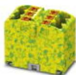
Verteilerblock, Grundklemme, Nennspannung: 450 V, Nennstrom: 24 A, Anschlussart: Push-in-Anschluss, Anzahl der Anschlüsse: 6, Querschnitt: 0,14 mm<sup>2</sup> - 4 mm<sup>2</sup>, AWG: 26 - 12, Breite: 16 mm, Höhe: 21,7 mm, Farbe: grün/gelb, Montageart: Fliegend, Direktmontage mit Flansch, kleben
