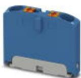
Verteilerblock, Grundklemme, Nennspannung: 450 V, Nennstrom: 24 A, Anschlussart: Push-in-Anschluss, Anzahl der Anschlüsse: 2, Querschnitt: 0,14 mm<sup>2</sup> - 4 mm<sup>2</sup>, AWG: 26 - 12, Breite: 5,2 mm, Höhe: 21,7 mm, Farbe: blau, Montageart: aufrasten auf Tragschienenadapter
