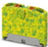
Verteilerblock, Grundklemme, Nennspannung: 450 V, Nennstrom: 24 A, Anschlussart: Push-in-Anschluss, Anzahl der Anschlüsse: 2, Querschnitt: 0,14 mm<sup>2</sup> - 4 mm<sup>2</sup>, AWG: 26 - 12, Breite: 5,2 mm, Höhe: 21,7 mm, Farbe: grün/gelb, Montageart: Fliegend, Direktmontage mit Flansch, kleben
