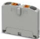
Verteilerblock, Grundklemme, Nennspannung: 450 V, Nennstrom: 24 A, Anschlussart: Push-in-Anschluss, Anzahl der Anschlüsse: 2, Querschnitt: 0,14 mm<sup>2</sup> - 4 mm<sup>2</sup>, AWG: 26 - 12, Breite: 5,2 mm, Höhe: 21,7 mm, Farbe: grau, Montageart: aufrasten auf Tragschienenadapter
