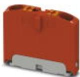
Verteilerblock, Grundklemme, Nennspannung: 450 V, Nennstrom: 24 A, Anschlussart: Push-in-Anschluss, Anzahl der Anschlüsse: 2, Querschnitt: 0,14 mm<sup>2</sup> - 4 mm<sup>2</sup>, AWG: 26 - 12, Breite: 5,2 mm, Höhe: 21,7 mm, Farbe: rot, Montageart: aufrasten auf Tragschienenadapter
