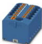
Verteilerblock, Grundklemme mit Einspeisung, Nennspannung: 450 V, Nennstrom: 24 A, Anschlussart: Push-in-Anschluss, Push-in-Anschluss, Anzahl der Anschlüsse: 13, Querschnitt: 0,14 mm<sup>2</sup> - 4 mm<sup>2</sup>, AWG: 26 - 12, Breite: 41 mm, Höhe: 21,7 mm, Farbe: blau, Montageart: aufrasten auf Tragschienenadapter, Adapterplatte
