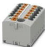
Verteilerblock, Grundklemme mit Einspeisung, Nennspannung: 450 V, Nennstrom: 24 A, Anschlussart: Push-in-Anschluss, Push-in-Anschluss, Anzahl der Anschlüsse: 13, Querschnitt: 0,14 mm<sup>2</sup> - 4 mm<sup>2</sup>, AWG: 26 - 12, Breite: 41 mm, Höhe: 21,7 mm, Farbe: grau, Montageart: aufrasten auf Tragschienenadapter, Adapterplatte
