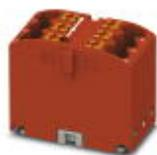
Verteilerblock, Grundklemme, Nennspannung: 450 V, Nennstrom: 24 A, Anschlussart: Push-in-Anschluss, Anzahl der Anschlüsse: 6, Querschnitt: 0,14 mm<sup>2</sup> - 4 mm<sup>2</sup>, AWG: 26 - 12, Breite: 16 mm, Höhe: 21,7 mm, Farbe: rot, Montageart: aufrasten auf Tragschienenadapter
