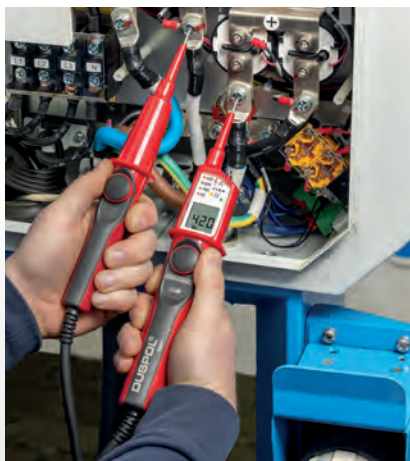
testen van de uitgangsspanning van een gelijkstroomoplader
