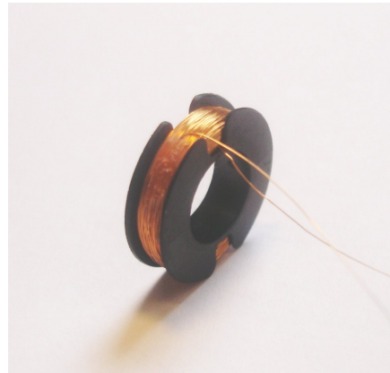
Fig. 5: Spoelvorm, kant en klaar gewikkeld
