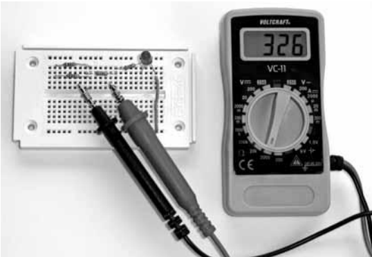
Afb. 59: U kunt afzonderlijke weerstanden alleen correct meten als er geen andere componenten parallel geschakeld zijn.
