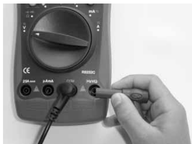
Afb 19: Voor spannings- en weerstandsmetingen moet u bij dit model het rode meetsnoer in de rechtse opening (HzVΩ) steken. Voor het meten van kleine stromen moet de aansluiting \mu mA worden gebruikt.
