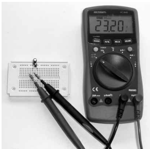
Afb. 41: Bij twee parallel geschakelde condensatoren van elk 10\ \mu\text{F} meet u de som van de afzonderlijke capaciteiten.
