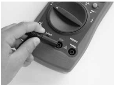
Afb. 18: Het zwarte meetsnoer moet aan COM worden aangesloten. Ze komt overeen met de retourleiding (de minpool).
