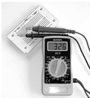
Afb. 27: Bij een correcte keuze van het meetbereik blijkt de oorspronkelijk als 1 \text{ k}\Omega gemeten weerstand, in werkelijkheid 330 \Omega te zijn.
