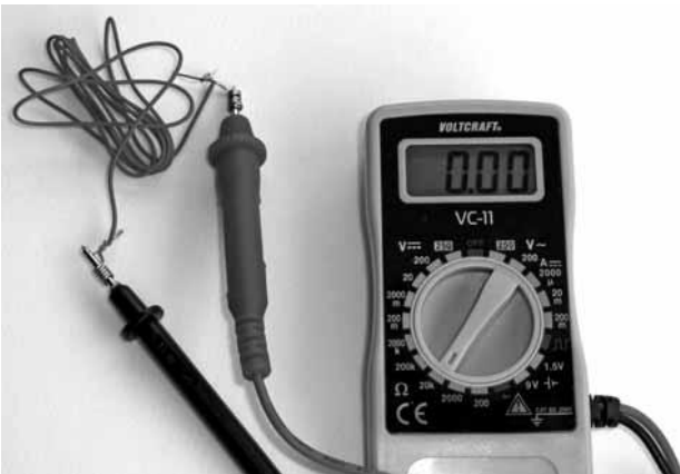
Afb. 52: Bepalen of er verbinding bestaat bij een kabel.
