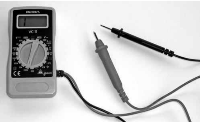
Afb. 51: Als de meetpennen van elkaar zijn gescheiden, dan is de weerstand oneindig groot en wordt "1--" getoond. Dat duidt op een kabelbreuk of bij een meeraderige kabel, dat de gemeten uiteinden niet bij dezelfde ader horen.
