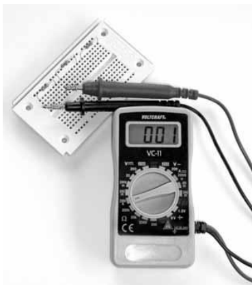
Afb. 25: In het hoogste meetbereik zijn de meetresultaten nog heel onnauwkeurig.
