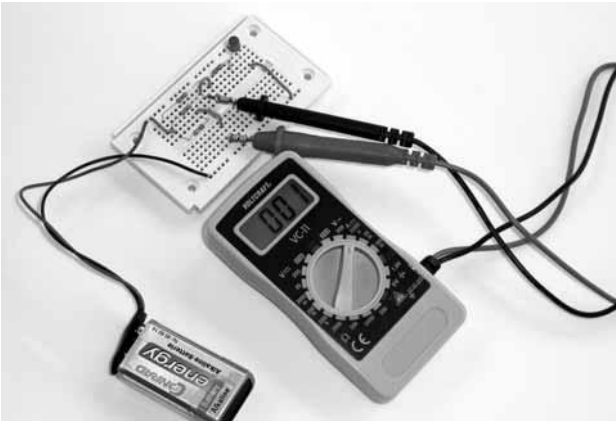
Afb. 64: Door de zeer hoge 2,2\text{ M}\Omega -weerstand loopt nauwelijks stroom. De gemeten stroom van 1\text{ mA} is alleen het gevolg van meetfouten. In werkelijkheid is de stroom veel kleiner.
