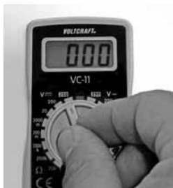
Afb. 21: Zet het instrument voor iedere meting op het hoogste meetbereik. Bij dit apparaat is dat voor gelijkspanning 250 V.
