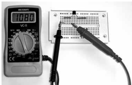
Afb. 73: Met een eenvoudige multimeter kunt u slechts globaal bepalen of de transistor in orde is. Om een NPN-transistor te testen, houdt u de rode meetpen tegen de basis en de zwarte tegen de collector en daarna tegen de emitter.
