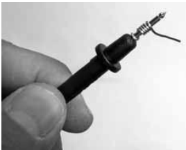
Afb. 23: Er worden 2 gestripte draadeinden van ongeveer 7 cm om de meetpennen gewikkeld.
