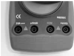
Afb. 17: De meeste multimeters hebben 3 of 4 aansluitingen voor de meetsnoeren, te gebruiken afhankelijk van de uit te voeren meting.
