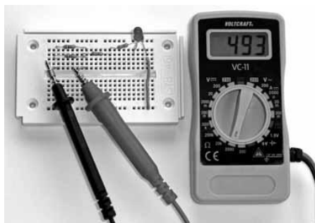
Afb. 57: Van de twee parallel geschakelde 1 \text{ k}\Omega -weerstand kan alleen de gezamenlijk weerstand van 493 \Omega worden gemeten.
