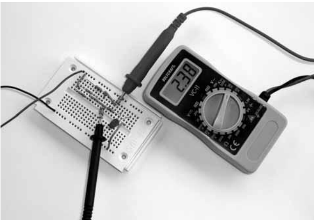
Afb. 65: Door elk van beide weerstanden van 330\ \Omega loopt ongeveer 2,4\text{ mA} .
