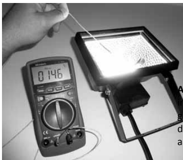
Afb. 79: Het zwarte meetsnoer moet worden aangesloten op de COM-aansluiting. Het rode meetsnoer gaat naar de \Omega\text{AmA}^\circ\text{C} -aansluiting.
