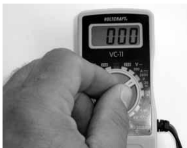
Afb 20: Let erop dat u de juiste te meten grootte selecteert (bijv. "gelijkstroom" als u gelijkstroom wilt meten).
