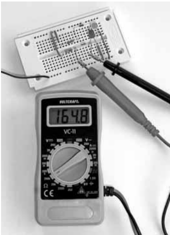
Afb. 71: U meet de diode in de doorlaatrichting als u de rode meetpen aan de kant van de ring tegen de diode houdt.
