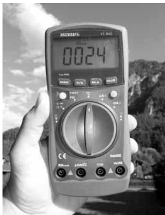
Afb. 77: Zodra u de multimeter op het meetbereik voor temperatuur hebt ingesteld, kunt u de omgevingtemperatuur meten.
