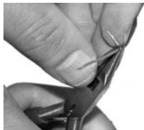
Afbeelding 29: De draad wordt met een elektronica rondtang recht gebogen.
