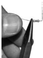
Afbeelding 30: Bij elektrische componenten mogen de draden niet direct aan de behuizing worden gebogen.
