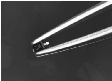
Afbeelding 14: SMD dioden zijn uiterst klein.
