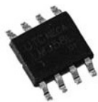
Afbeelding 16: Bij de SMD-IC is PIN 1 gemarkeerd door een punt aan de boven kant van de behuizing.
