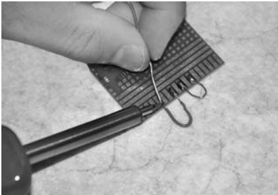
Afbeelding 31: Draadbruggen solderen aan een zijdelings stramien
