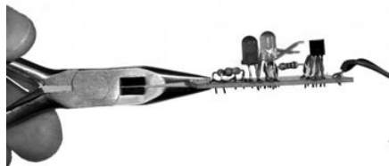
Afbeelding 62: De afgeknepen aansluitingen moeten 0,5 - 1 mm uit de platine steken.
