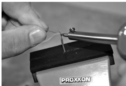
Afbeelding 27: Aan de verwrongen draad moet een beetje soldeer worden toegevoegd, dat onmiddellijk smelt.
