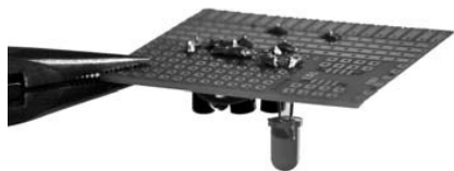
Afbeelding 63: Aansluitdraden moeten net boven de soldeerkegels worden afgeknepen.
