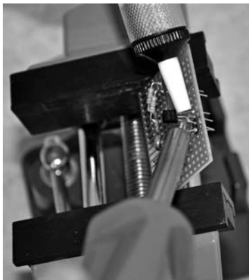
Afbeelding 57: Soldeerklonten kunnen door verhitten en opzuigen met de lossmelpomp worden verwijderd.
