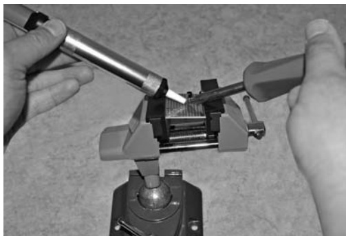
Afbeelding 65: Het lossmelten kan alleen met behulp van de lossmeltzuigpomp.
