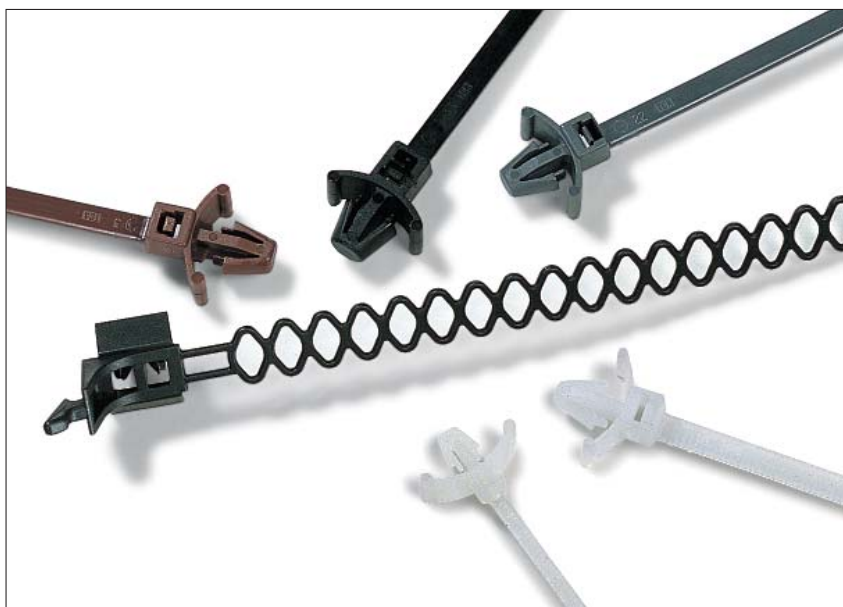
Bevestigingsbanden met spreidanker zijn geschikt voor plaatdiktes van 0,5 mm tot 4,0 mm en boorgatdiameters van 4,65 tot 8,2 mm.
