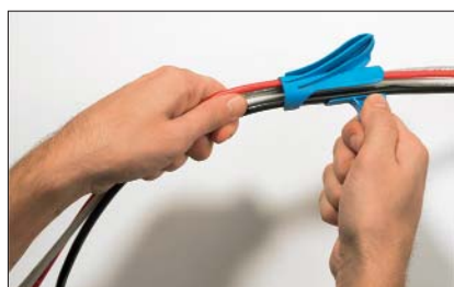
Leg een of meerdere kabels in het toeltje.
