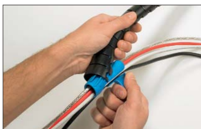
Zet het toeltje aan een van de uiteinden van de slang.
