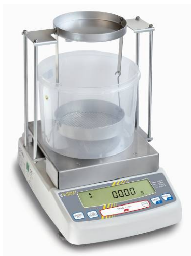
Afb. 1: Geïnstalleerde set voor dichtheidsbepalingen KERN PBS-A04
