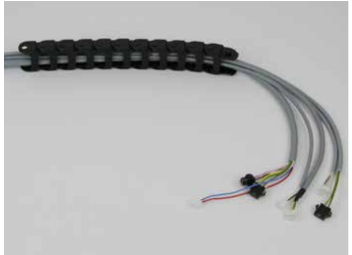
Plaats de kabels in de sleepketting met het uiteinde zonder label (met kabelnummer) aan de kant van het eindstuk met de pal.
