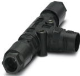
QUICKON-T-verdeler, zwart, 4+PE-polig, 1,0 mm 2 ... 2,5 mm 2 / 690 V / 20 A, voor kabeldiameters van 9 mm ... 16 mm, met twee QUICKON-moeren
