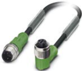
Sensor-/actorkabel, 3-polig, PUR halogeenvrij, zwartgrijs RAL 7021, connector recht M12, A-gepolariseerd, op bus haaks M12, A-gepolariseerd, kabellengte: 0,6 m
