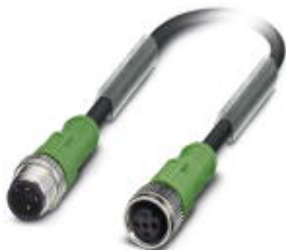
Sensor-/actorkabel, 3-polig, PUR halogeenvrij, zwartgrijs RAL 7021, connector recht M12, A-gepolariseerd, op bus recht M12, A-gepolariseerd, kabellengte: 0,3 m
