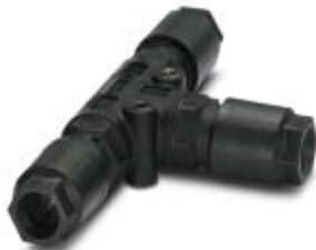
QUICKON-T-verdeler, zwart, 4+PE-polig, 1,0 mm 2 ... 2,5 mm 2 / 690 V / 20 A, voor kabeldiameters van 9 mm ... 16 mm, met drie QUICKON-moeren
