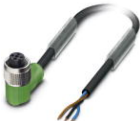
Sensor-/actorkabel, 3-polig, PUR halogeenvrij, zwartgrijs RAL 7021, vrij kabeluiteinde, op bus haaks M12, A-gepolariseerd, kabellengte: 1,5 m
