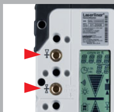
Verandering van de houderklempositie: instelhoogte wordt aangepast
