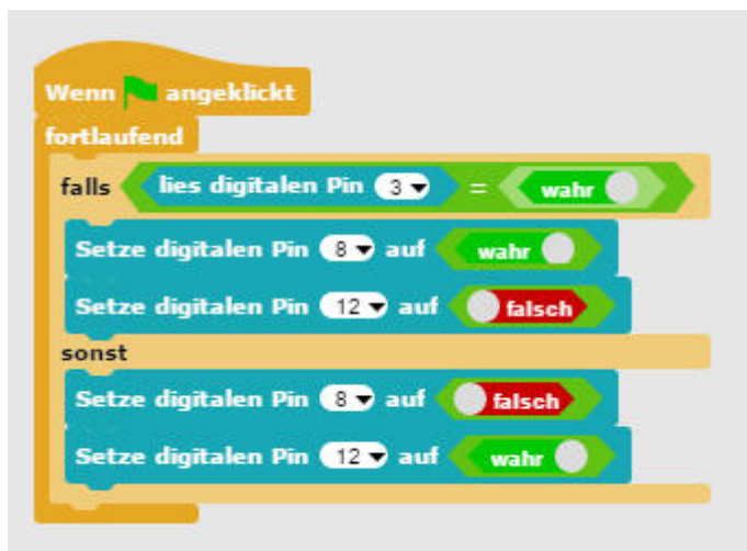
Het programma 061ed06 schakelt twee LED's om met een knop.
