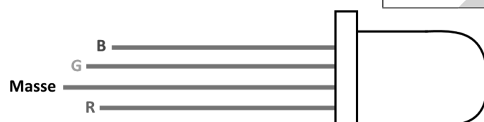
Aansluitpins van een RGB-LED
