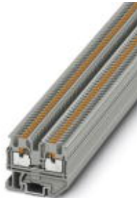
Mini-aansluitklem, Aansluitmethode: Push-in-aansluiting, aantal aansluitingen: 2, doorsnede: 0,14 mm 2 - 1,5 mm 2 , AWG: 26 - 14, breedte: 3,5 mm, kleur: blauw, montagetechniek: NS 15
