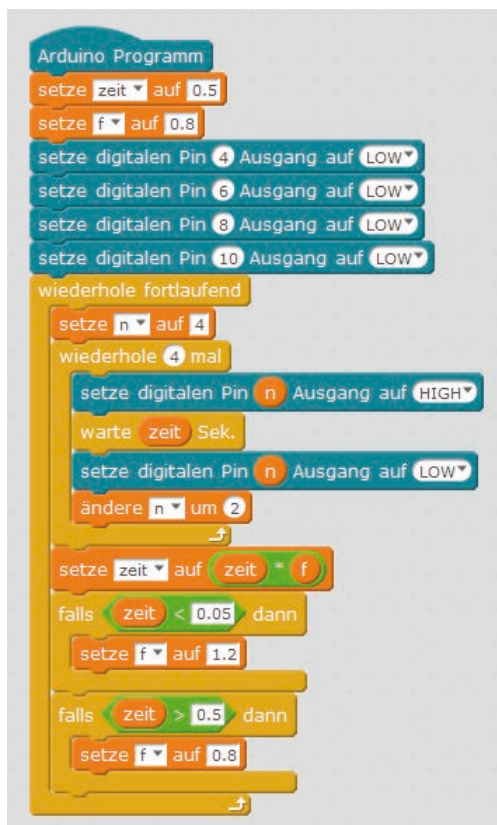
Het programma 10mblock laat de leds als looplicht met wisselende snelheid oplichten.
