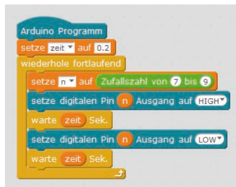
Het programma 07mblock01 laat drie leds willekeurig blinken.
