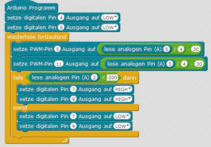
Het programma 16mBlock bestuurt twee RGB-leds via een Potentiometer en een sensorcontact.
