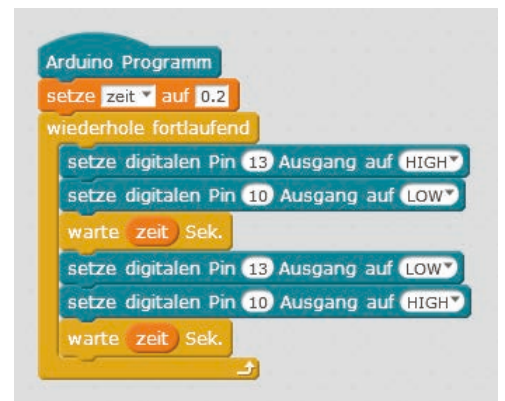
Het programma 03mblock laat afwisselend twee leds met een instelbare snelheid knipperen.
