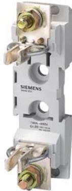
NH-Sicherungsunterteil Gr. 00, 1-polig 160A 690V (1000V) mit Flachanschluss zum Aufschnappen auf Hutschiene
