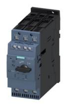
Leistungsschalter Baugröße S2 für den Motorschutz, CLASS 10 A-Auslöser 42...52 A N-Auslöser 741 A Schraubanschluss erhöhtes Schaltvermögen mit querliegenden Hilfsschalter 1S+1Ö
