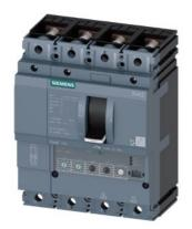
Leistungsschalter 3VA2 IEC Frame 160 Schaltvermögenklasse H Icu=85kA @ 415V 4-polig, Anlagenschutz ETU330, LIG, In=40A Überlastschutz Ir=16A...40A Kurzschlussschutz Ii=1,5...12 x In N-Leiterschutz einstellbar (OFF, 100%) Erdschlussschutz Ig=0,4...1 x In= tg=0,1/0,3s Schraubenflachanschluss
