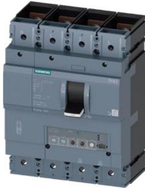
Leistungsschalter 3VA2 IEC Frame 400 Schaltvermögenklasse H Icu=85kA @ 415V 4-polig, Anlagenschutz ETU330, LIG, In=400A Überlastschutz Ir=160A...400A Kurzschlusschutz Ii=1,5...10 x In N-Leiterschutz einstellbar (OFF, 50%, 100%) Erdschlusschutz Ig=0,2...1 x In= tg=0,1/0,3s Schraubenflanschanschluss
