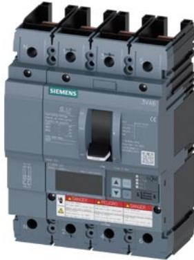
Leistungsschalter 3VA6 UL Frame 250 Schaltvermögenklasse H 65kA @ 480V 4-polig, Anlagenschutz ETU830, LIG, In=250A Überlastschutz Ir=100A...250A Kurzschlusschutz Ii=1,5...10 x In Erdschlusschutz Ig=0,2...1 x In, tg=0,05-0,8s ohne Anschluss
