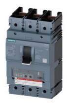
Leistungsschalter 3VA6 UL Frame 600 Schaltvermögenklasse H 65kA @ 480V 3-polig, Anlagenschutz ETU330, LIG, In=400A Überlastschutz, 100% rated Ir=160A...400A Kurzschlussschutz Ii=1,5...12 x In Erdschlussschutz Ig=0,2...1 x In, tg=0,1/0,3s ohne Anschluss
