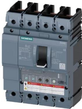
Leistungsschalter 3VA6 UL Frame 250 Schaltvermögenklasse C 100kA @ 480V 4-polig, Anlagenschutz ETU330, LIG, In=250A Überlastschutz Ir=100A...250A Kurzschlusschutz Ii=1,5...10 x In N-Leiterschutz einstellbar (OFF, 50%, 100%) Erdschlusschutz Ig=0,2...1 x In= tg=0,1/0,3s ohne Anschluss
