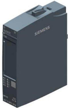
SIMATIC ET 200SP, Digitales Eingangsmodul, DI 8x 24VDC Standard, Eingangstyp 3 (IEC 61131), Sink Input, (PNP, P-lesend), Verpackungseinheit: 1 Stück, passend für BU-Typ A0, Farbcode CC01, Eingangsverzögerung 0,05..20ms; Modul-Diagnose für: Kurzschluss Gebersversorgung, Drahtbruch, Versorgungsspannung
