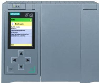
SIPLUS S7-1500 CPU 1518F-4 PN/DP based on 6ES7518-4FP00-0AB0 mit Conformal Coating, 0...+60°C, Zentralbaugruppe mit Arbeitsspeicher 4,5 MByte für Programm und 10 MByte für Daten, 1. Schnittstelle: PROFINET IRT mit 2 Port Switch, 2. Schnittstelle, Ethernet, 3. Schnittstelle, Ethernet, 4. Schnittstelle, PROFIBUS, 1 NS Bit-Performance, SIMATIC Memory Card notwendig
