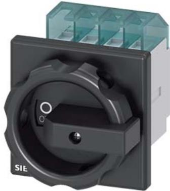
SENTRON, Lasttrennschalter 3LD, Hauptschalter, 3-polig, I<sub>n</sub>: 16 A, Betriebsleistung / bei AC-23 A bei 400V: 7,5 kW, Frontbefestigt, Drehantrieb, schwarz, 4-Loch Befestigung der Handhabe
