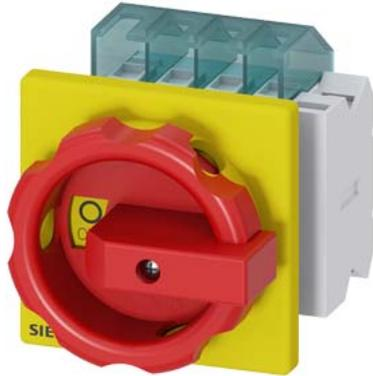
SENTRON, Lasttrennschalter 3LD, Not-Aus-Schalter, 4- polig, Iu: 16 A, Betriebsleistung / bei AC-23 A bei 400V: 7,5 kW, Frontbefestigt, 1Ö, 1S, Drehantrieb, rot/gelb, 4-Loch Befestigung der Handhabe
