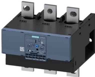
Überlastrelais 160...630 A für Motorschutz Baugröße S10/S12, CLASS 5...30E Schützenbau/Einzelaufstellung Hauptstromkreis: Schienenanschl. Hilfsstromkreis: Federzugklemme Hand-Automatik-RESET interne Erdschlusserkennung
