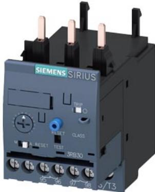
Überlastrelais 6...25 A elektronisch für Motorschutz Baugröße S0, CLASS 10E Schützenbau Hauptstromkreis: Schraub Hilfsstromkreis: Schraub Hand-Automatik-RESET
