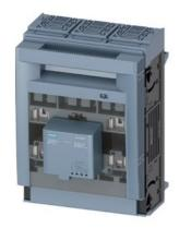
SENTRON, Sicherungslasttrennschalter 3NP1, 3-polig, NH2, 400 A, für Sammelschienensystem Rittal 60mm, Flachanschluss, Sicherungsüberwachung: elektronisch EFM10, Abdeckebene 32/70mm
