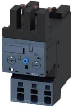
Überlastrelais 3...12 A elektronisch für Motorschutz Baugröße S0, CLASS 5...30 Schützenbau Hauptstromkreis: Federzugklemme Hilfsstromkreis: Federzugklemme Hand-Automatik-RESET interne Erdschlusserkennung
