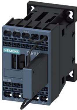
Bahnschütz, AC-3 12 A, 5,5 kW / 400 V DC 110 V, 0,7-1,25\*US mit Suppressordiode integriert 3-polig, Baugröße S00 Federzuganschluss geeignet für SPS-Ausgänge nicht mit Hilfsschalter erweiterbar
