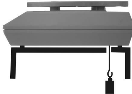
Afbeelding 1 Instellen van de weegschaal voor ondergrondse wegingen
