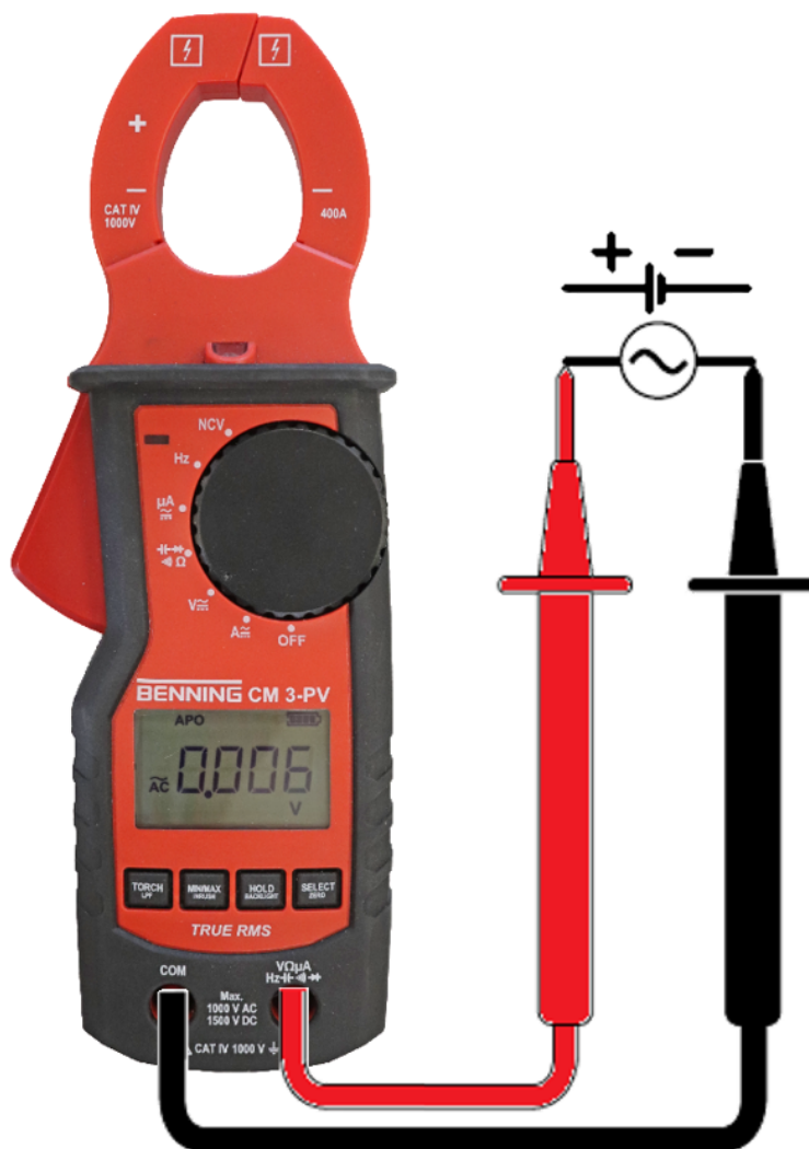
Afbeelding 9: Gelijk- en wisselspanningsmeting
