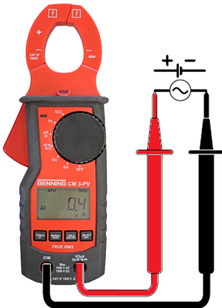
Afbeelding 11: Stroomsterktemeting m.b.v. de veiligheidsmeetkabels ( \mu\text{A} )
