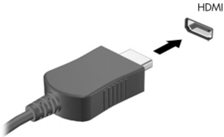
2. Koble til den andre enden av kabelen til en HDTV eller -skjerm.
