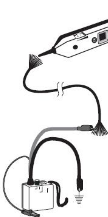
Rys. 4a Lokalizowanie kabla
